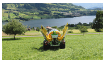
Aufklappmechanismus des CONTACT Fass Profi 10.5 | Mécanisme de replisage du CONTACT Citerne Profi 10.5
