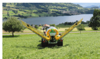
Aufklappmechanismus des CONTACT Fass Profi 10.5 | Mécanisme de replisage du CONTACT Citerne Profi 10.5
